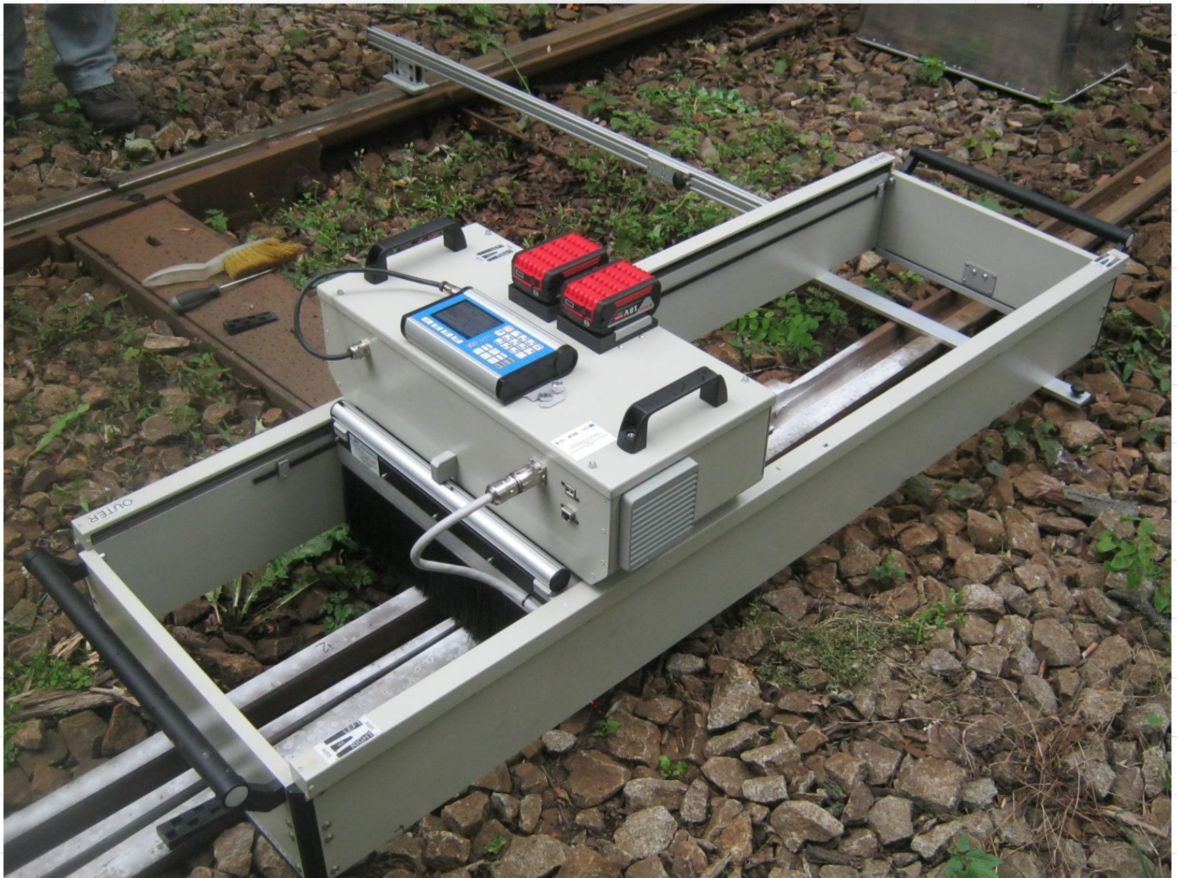
Skaner laserowy do diagnostyki szyn i elementów rozjazdów
