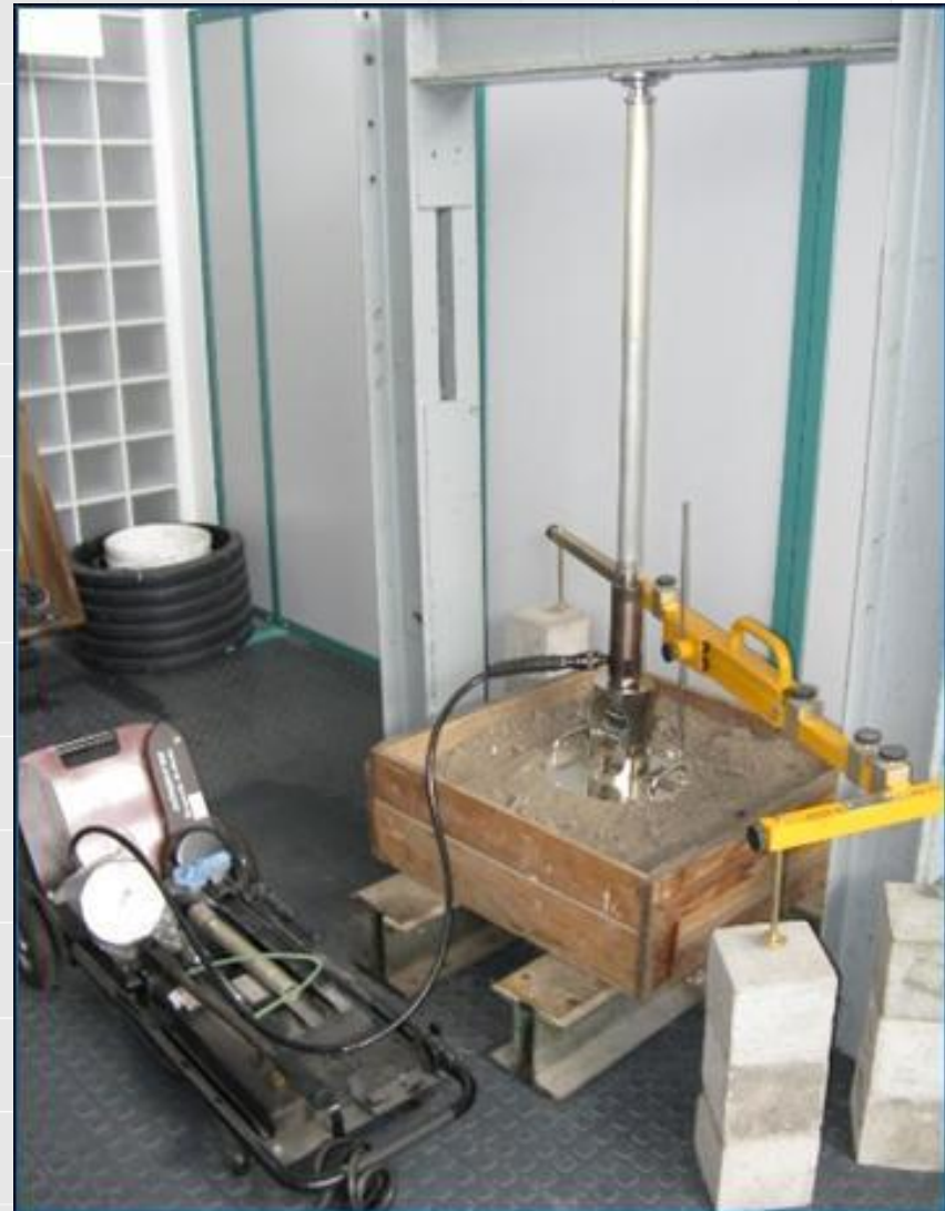
Płyta VSS do badań nośności gruntu
