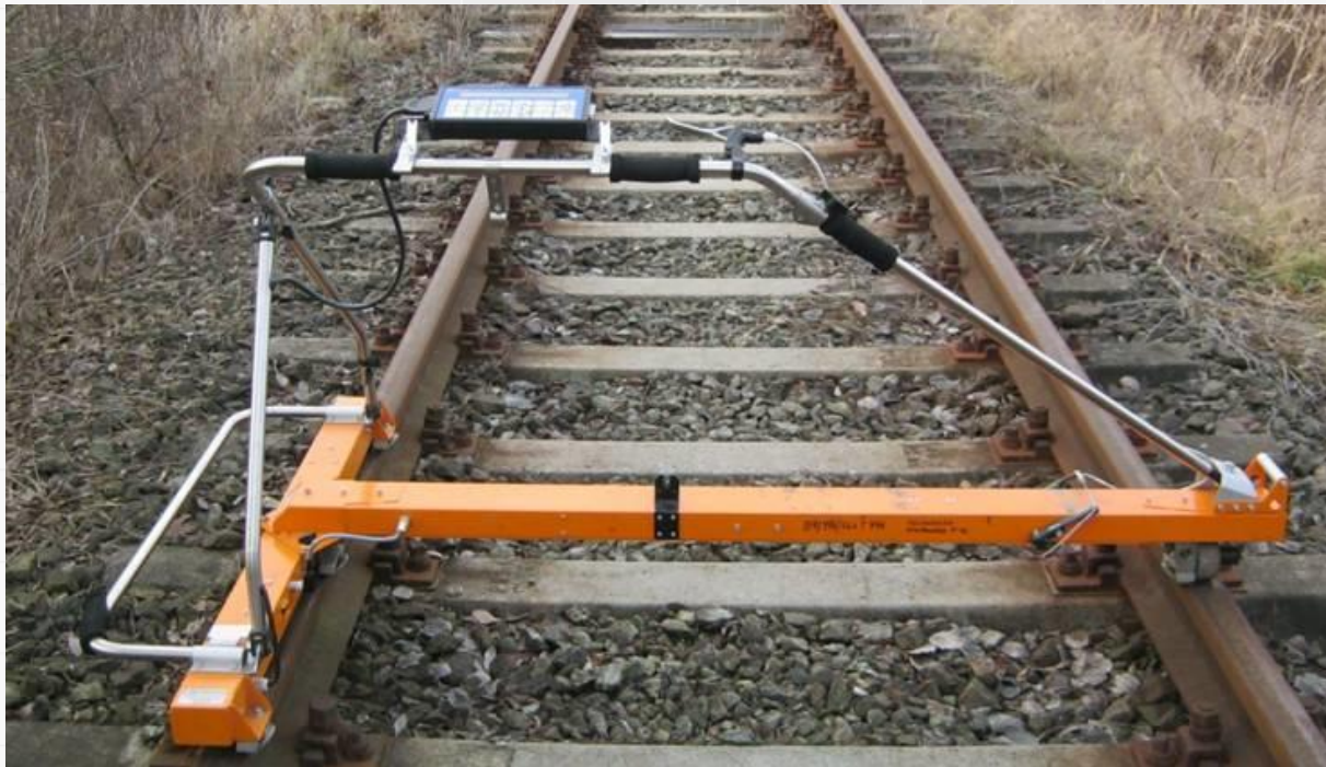
Elektroniczny toromierz samorejestrujący do pomiarów ciągłych
